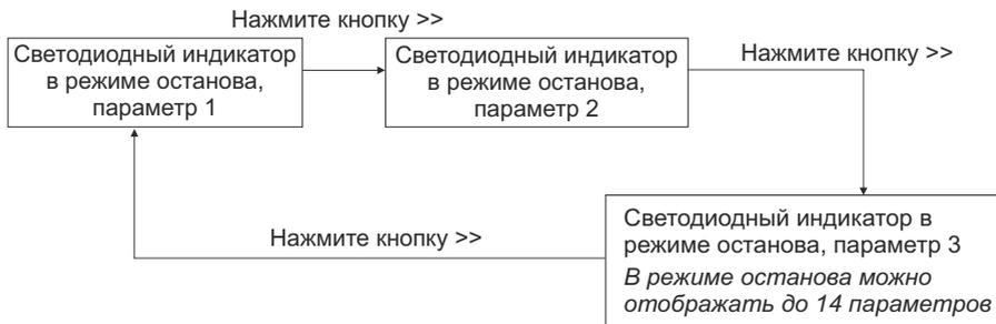
В состоянии останова возможно циклическое отображение в общей сложности 14 параметров, конкретное содержимое для циклического отображения определяется функциональным кодом P5.0.05.
