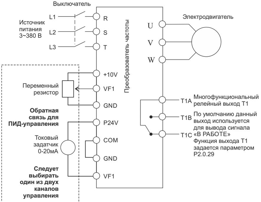
Если используется дистанционный манометр, переключатель J5-1 (DIP переключатель входной клеммы VF1) должен находиться в положении U, если применяется датчик давления, переключатель J5-1 должен находиться в положении I.
