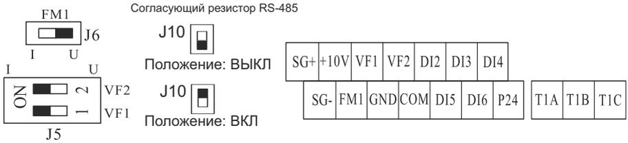
Стандартная конфигурация для преобразователей частоты серии MCI
