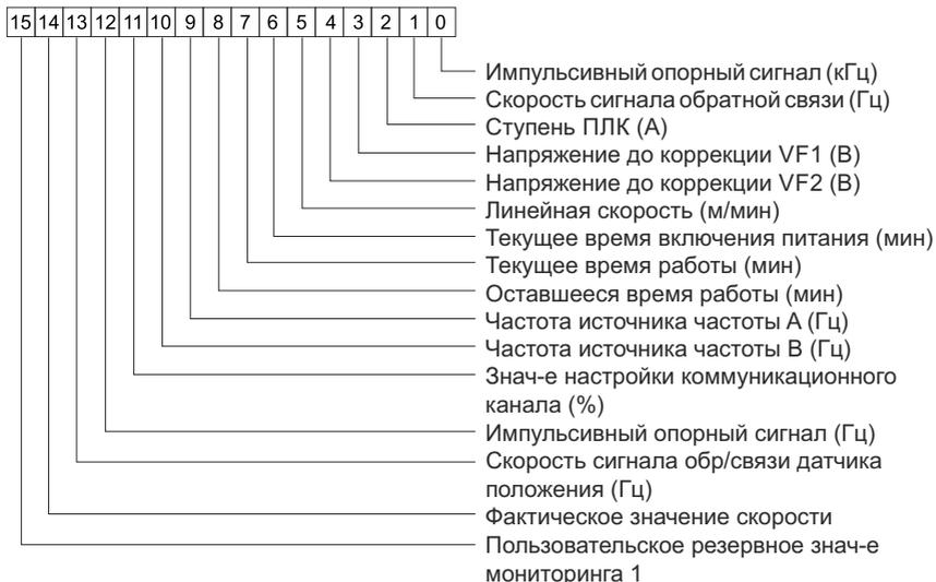
Если во время работы необходимо отобразить один из перечисленных выше параметров, установите соответствующий разряд равным 1, затем переведите значение из двоичной системы в шестнадцатеричную и сохраните в качестве значения кода P5.0.03.
