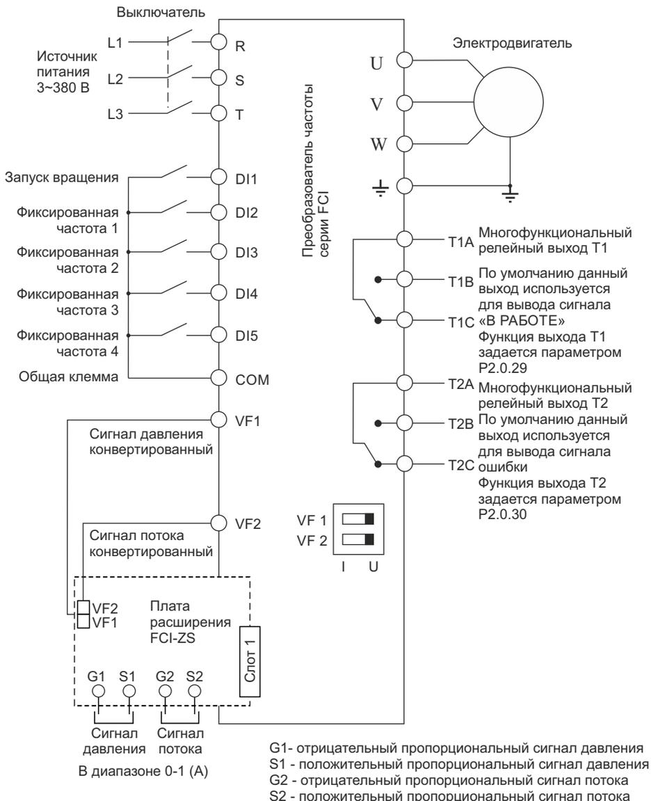
Значения функциональных кодов в режиме инжекционно-литьевой машины при подключении преобразователя частоты для серии FCI (при выборе режима инжекционно-литьевой машины установите значение функционального кода P5.0.19 равным 103)
