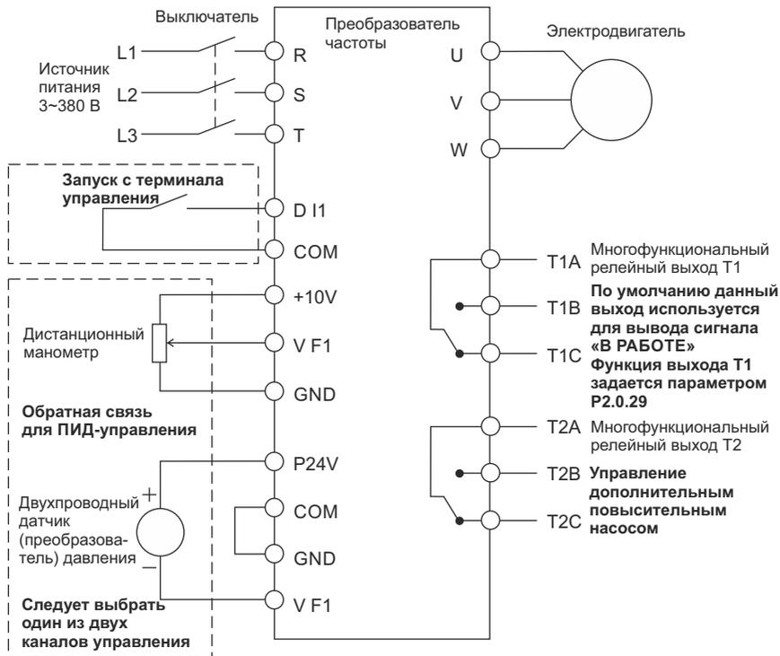
Замечание: Если используется дистанционный манометр, переключатель J5-1 (DIP переключатель входной клеммы VF1) должен находиться в положении U, если применяется датчик давления, переключатель J5-1 должен находиться в положении I.
