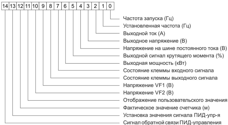
Если во время работы необходимо отобразить один из перечисленных выше параметров, установите соответствующий разряд равным 1, затем переведите значение из двоичной системы в шестнадцатеричную и сохраните в качестве значения кода P5.0.02
