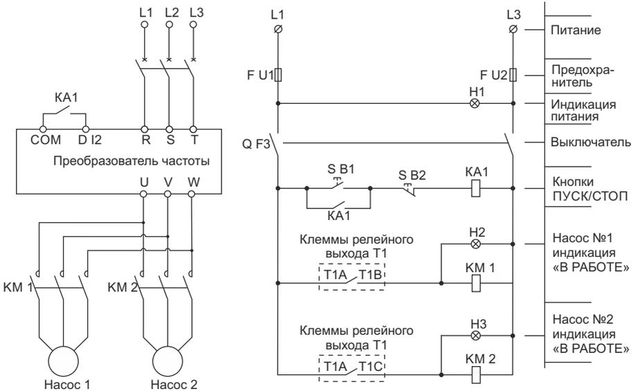
Значения функциональных кодов для режима поочередного управления двумя насосами для серии MCI (при выборе режима поочередного управления двумя насосами, установите значение функционального кода P5.0.19 равным 100)
