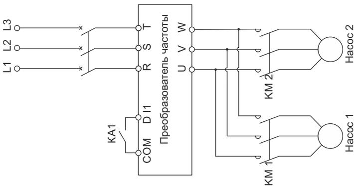
Значения функциональных кодов для режима поочередного управления двумя насосами для серии FCI (при выборе режима поочередного управления двумя насосами, установите значение функционального кода P5.0.19 равным 100)
