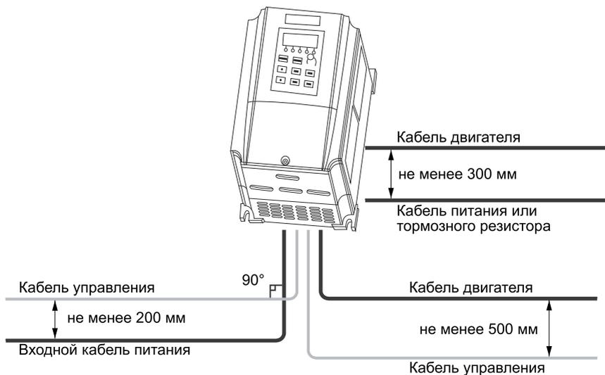
Все кабели управления должны быть экранированными. Для аналоговых сигналов следует использовать кабель типа «витая пара» с двойным экраном (см. рис. «А» ниже). Каждый сигнал должен быть подключен с помощью отдельной экранированной пары. Не следует использовать один общий провод для разных аналоговых сигналов. Для низковольтных цифровых сигналов лучше всего подходит кабель с двойным экраном, однако можно использовать и кабель типа «витая пара» с одним экраном рис. «Б».
